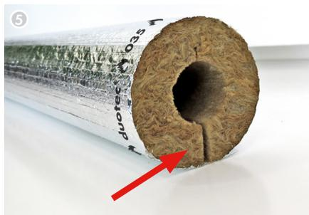
Zur Minimierung des Wärmeverlustes bei waagrecht Montage die Längsnaht so ausrichten, dass sich diese unten am Rohr befindet! <sup>1)</sup>
